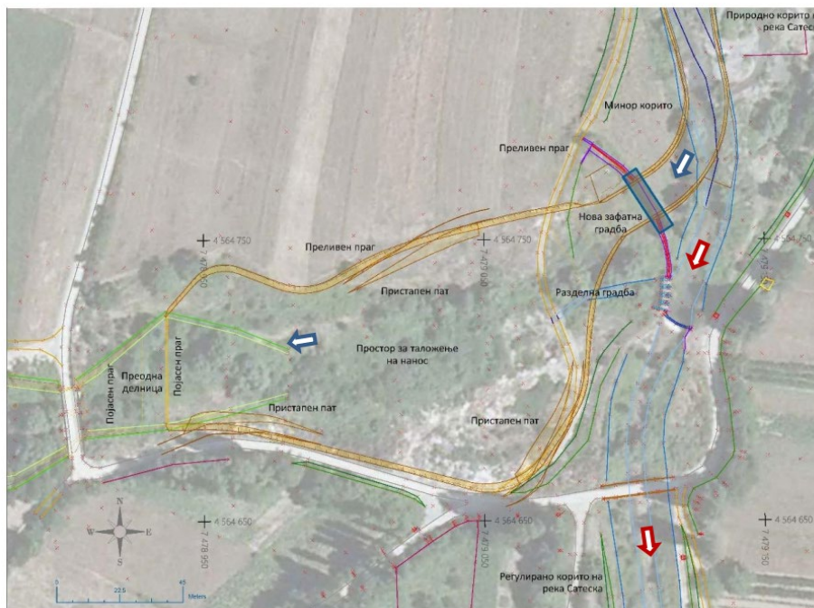
Слика Пренасочување на коритото на река Сатеска и фаќање на предвидените количини - Алтернатива 2
